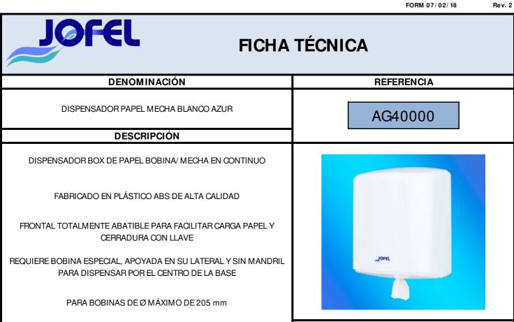
LA BOBINA SE COLOCA, UNA VEZ EXTRAIDO EL MANDRIL, SOBRE EL LADO **PLANO**
